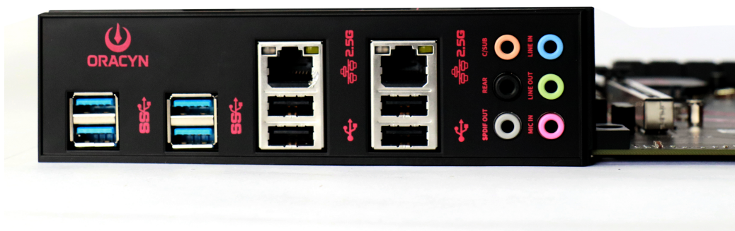
Figura 2 — Painel traseiro (I/O) com todos os conectores identificados
