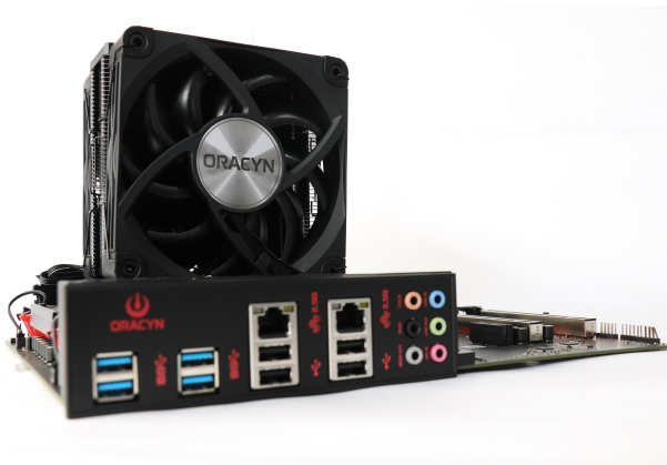
Vista do painel traseiro com cooler de CPU instalado
