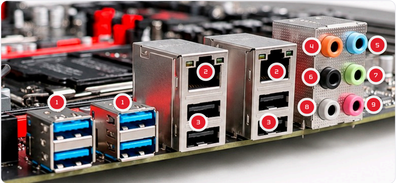
FIG. 2 Painel traseiro com os conectores numerados
