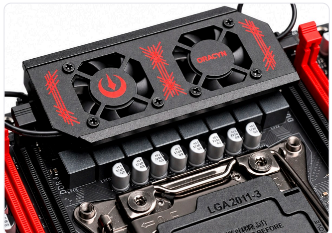
FIG. 13 Detalhe dos dissipadores com ventoinhas
