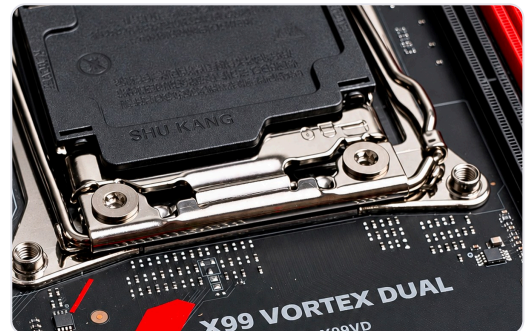
FIG. 3 Soquete LGA 2011-3 com a tampa protetora
